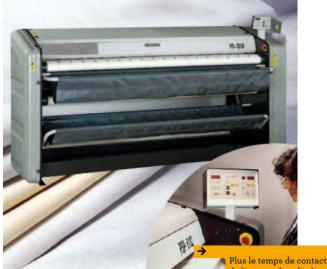
rius le temps ac contact du linge sur le cylindre chauffant est grand, meilleur sera le rendement et le séchage. Plus le diamètre est grand, plus on pourra aller vite.
